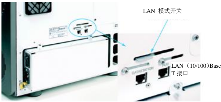
图 6：仪器背面的 LAN 接口 和 LAN 模式开关。
