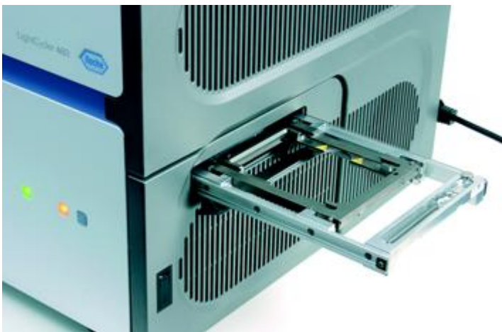
图 11： 仪器多孔板加载器伸出视图。
