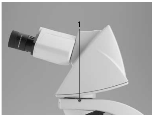
Fig. 11 Fixation du tube 1 Vis de serrage
