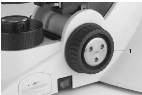
Fig. 5 Bouton de mise au point 1 Fixation aimantée du bouton de mise au point fine
