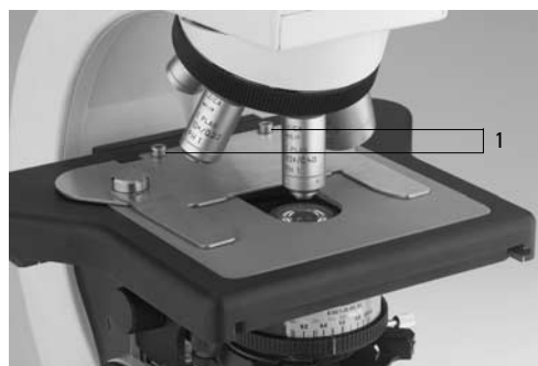
Fig. 4 Platine porte-objet avec support de préparation 1 Vis de fixation pour le support de préparation
