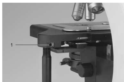
图.7 同轴小齿轮的安装 1 同轴小齿轮固定螺钉
