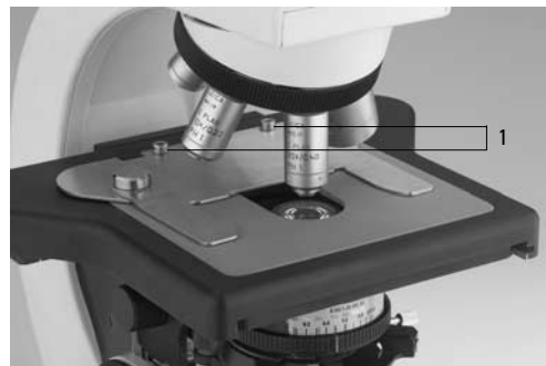
Abb. 4 Objektisch mit Präparatehalter 1 Befestigungsschrauben für Präparatehalter
