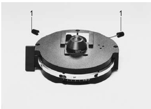
图. 38 光圈中心定位 (即: 聚光器UCA/P) 1中心定位键
